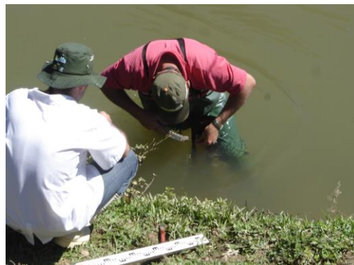
Conserto de réguas na estação Divisa de Anitápolis
