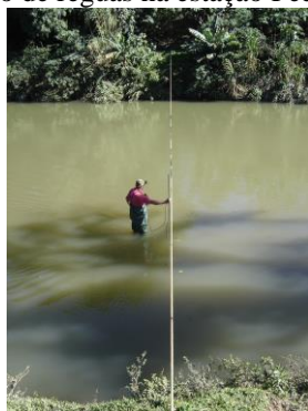
Medição de descarga líquida na estação Divisa de Anitápolis
