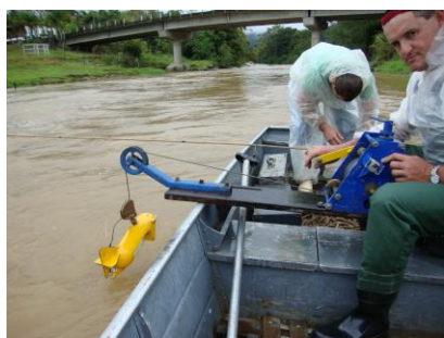
Medição de sedimento na estação Poço Fundo
