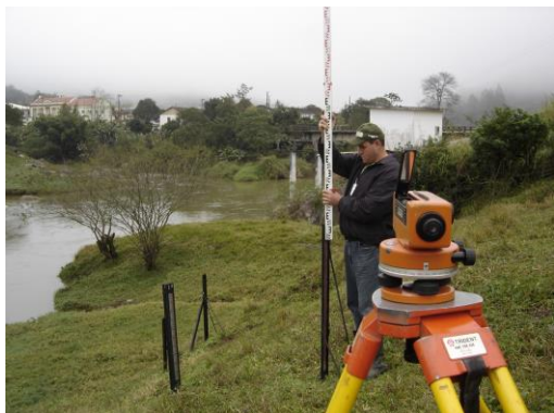
Nivelamento de réguas na estação Pedras Grandes
