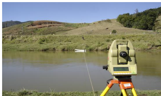
Batimetria e medição de descarga líquida na Estação Pedras Grandes
