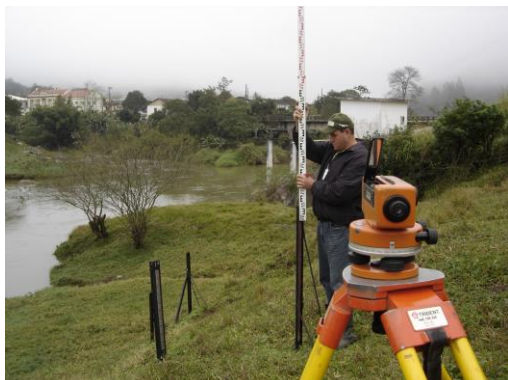
Nivelamento de réguas na estação Pedras Grandes
