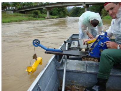
Medição de sedimento na estação Poço Fundo
