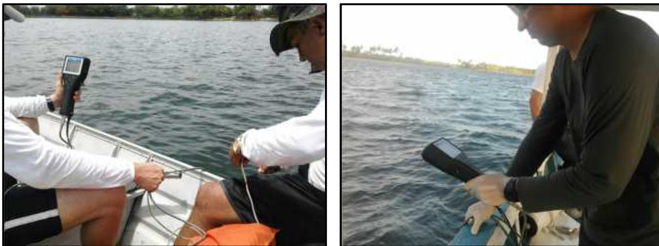
Figura 2.5. Medição in situ das variáveis de pH, condutividade, temperatura, oxigênio dissolvido, turbidez, salinidade e transparência com o auxílio de equipamento mutiparâmetro. Fotos: CARUSO JR., 2016.
