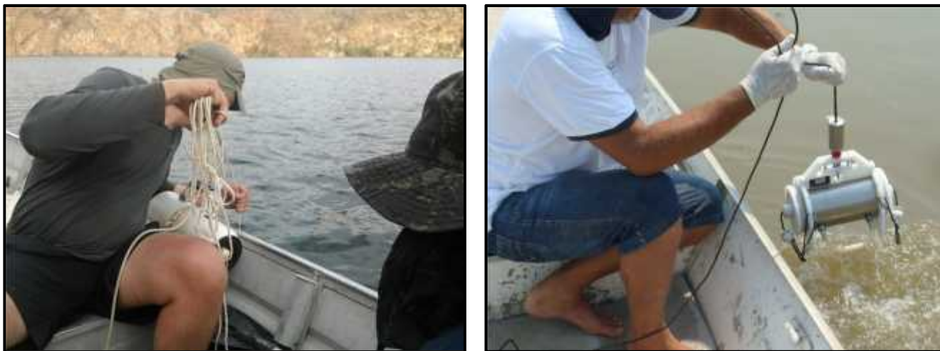
Figura 2.3. Coleta das amostras de água com auxílio de amostrador de profundidade do tipo van Dorn . Fotos: CARUSO JR., 2016.
